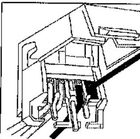
Repita los pasos 15 y 16 con el otro conductor, pero en el orificio que queda libre junto al segundo conductor conectado.
